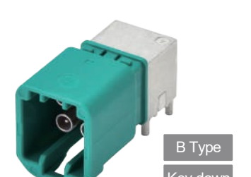
410A(B2) Mini FAKRA Plug 2x2 Right Angle Type Coding:A,B,C,D,E,F,Z Positions:04
